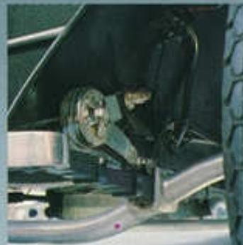
Train avant: gros plan sur lames de suspension et amortisseur à friction.
