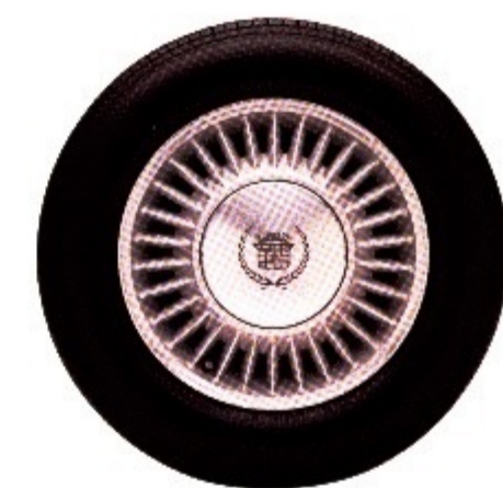
STANDARD 16"x17" CAST ALUMINUM ALLOY WHEEL—ELDORADO.
